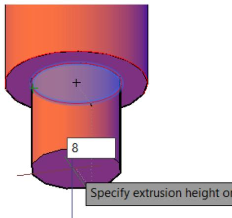
*Figura 5.124. Presspull de altura 8.*
