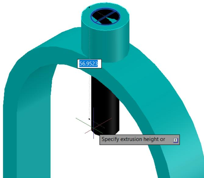
***Figura 5.116. Ejecutando comando presspull.***
