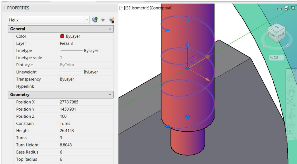
**Figura 5.134. Configuración de hélix.**
