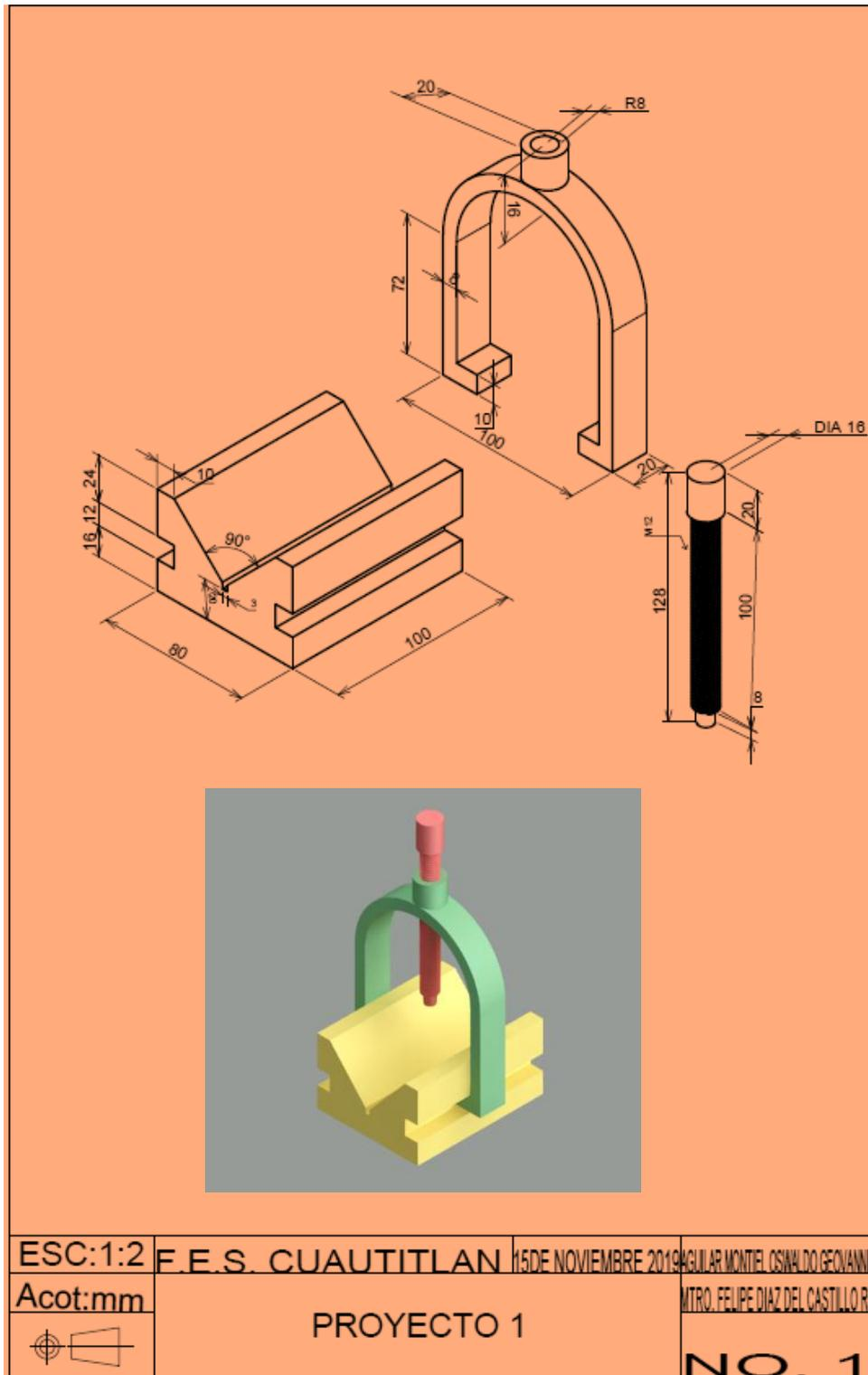
*Figura 5.92. Dibujo de conjunto del ensamble a desarrollar*
